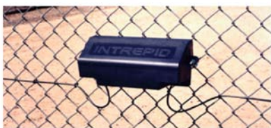
图 6.9 围栏上的处理器接地连接单元
